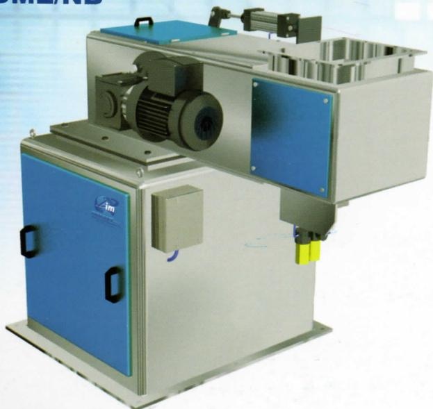
Banda transportadora accionada por moto reductor y control de velocidad para el llenado grueso y llenado fino, regulación de flujo por compuerta ajustable accionada neumáticamente. Indicado para productos texturizados de flujo irregular como alimentos concentrados, minerales, harinas, polvos, etc.
