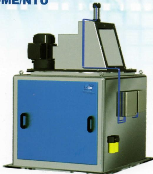
Turbina accionada por motor y regulación de flujo para el llenado grueso y llenado fino mediante compuertas accionadas por cilindros neumáticos. Ideal para productos harinosos.
